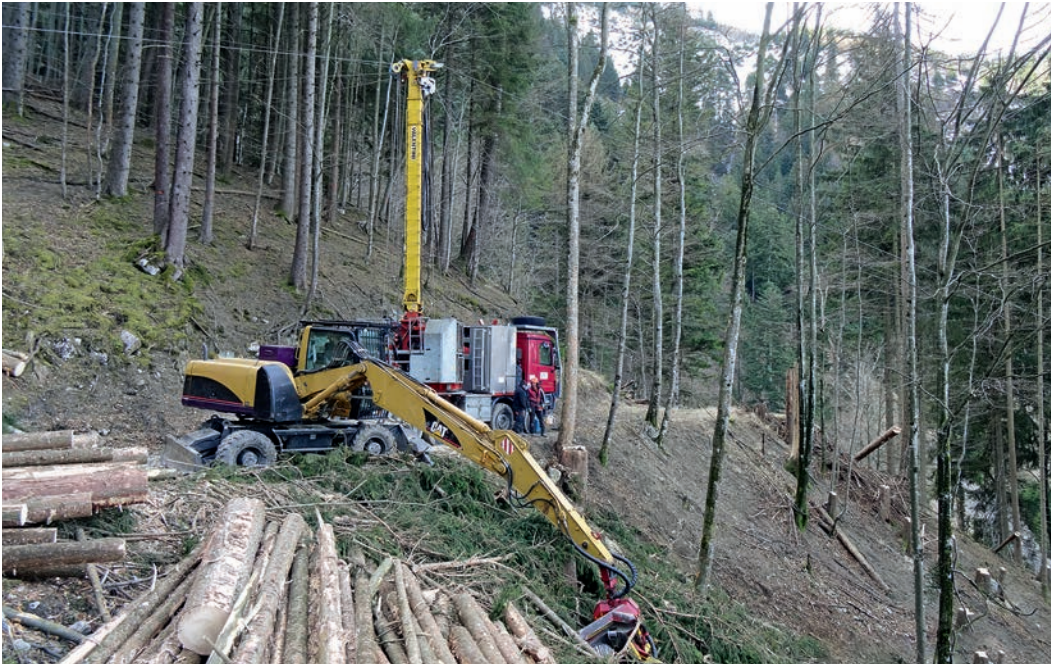
Die Seilbahn sowie der Baggerprozessor im Einsatz beim Josefsheim.
