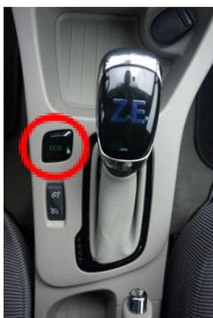
Das Auto verfügt zudem über einen ECO-Fahrmodus mit dem Sie den Stromverbrauch reduzieren können. Diese Einstellung können Sie an der Mittelkonsole betätigen.
