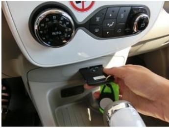
Der Schlüssel wird in den Schlitz in der Mittelkonsole gesteckt.
