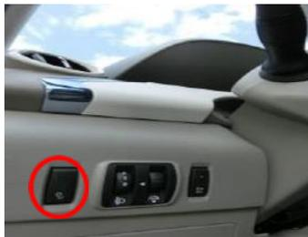
Öffnen Sie die Tankklappe mit dem Schlüssel oder mit dem Entriegelungs-knopf links neben dem Lenkrad.
