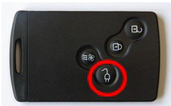
durch Drücken des Knopfes „Steckersymbol“ am Fahrzeugschlüssel.
