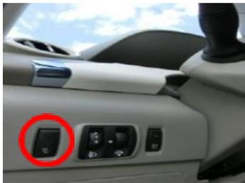
Die Entriegelung des Kabels am Fahrzeug erfolgt durch Drücken des Knopfes links neben dem Lenkrad
