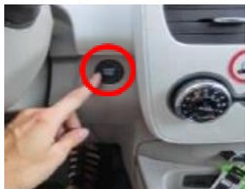
Betätigen Sie anschliessend die Fussbremse und drücken Sie den START/STOP Knopf kurz.
